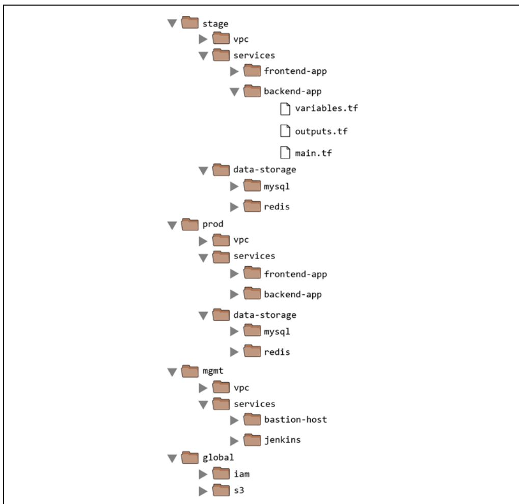
Rysunek 3.7. Typowy układ plików w projekcie Terraform korzysta z oddzielnych katalogów dla poszczególnych środowisk i komponentów w tych środowiskach
